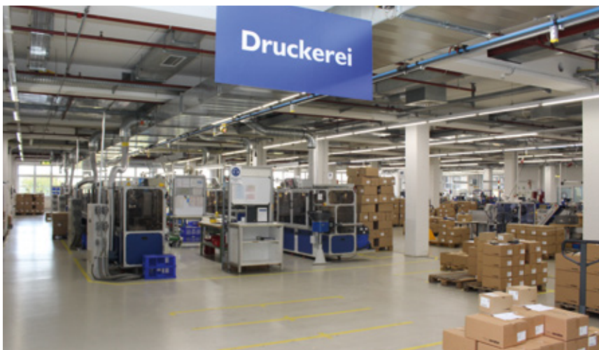
In der Druckerei werden sämtliche gängigen Individualisierungstechniken – von Tampon- über Sieb-, High Definition- und Digitaldruck bis hin zur Lasergravur – durchgeführt. Permanent wird in neue Maschinen investiert.
